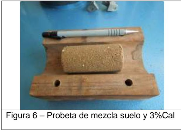
Figura 6 – Probeta de mezcla suelo y 3%Cal
