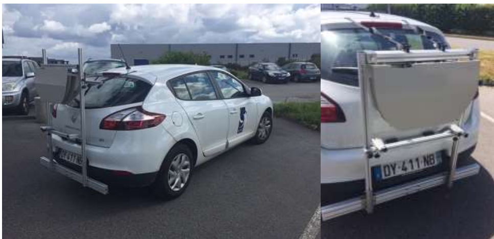
Figura 19: Ejemplos de Multifunción: Regularidad Longitudinal (IRI) y macrotextura agregados al Sistema
