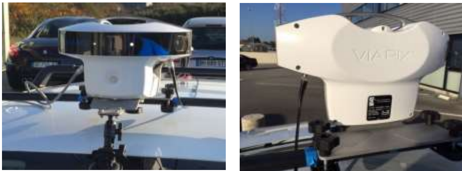
Figura 5: Sistema de Video y Mapeo Móvil con cobertura 180° instalado en un vehículo
