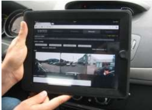
Figura 8: Tableta táctil WiFi–Notebook conectada a la interfase Web del sistema de adquisición
