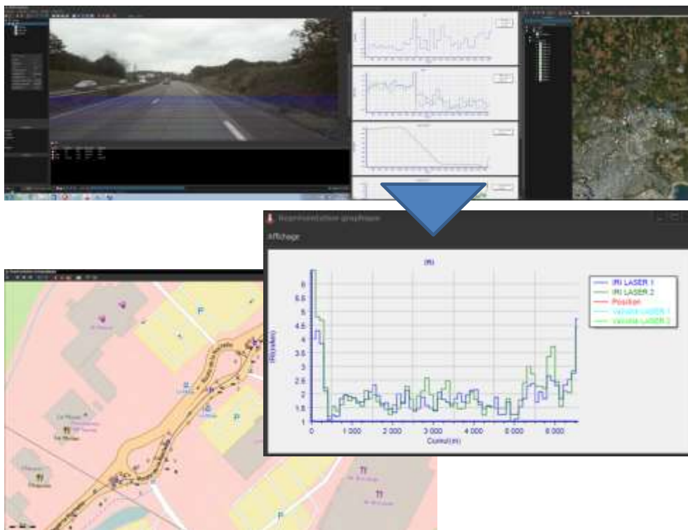
Figura 21: Ejemplos de explotación de datos e integración gráfica de indicadores (IRI)
