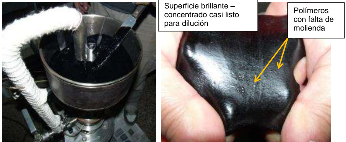
FOTO 5. MUESTRA DEL CONCENTRADO A 190°C PARA ENSAYO “DE LA PIZZA”
