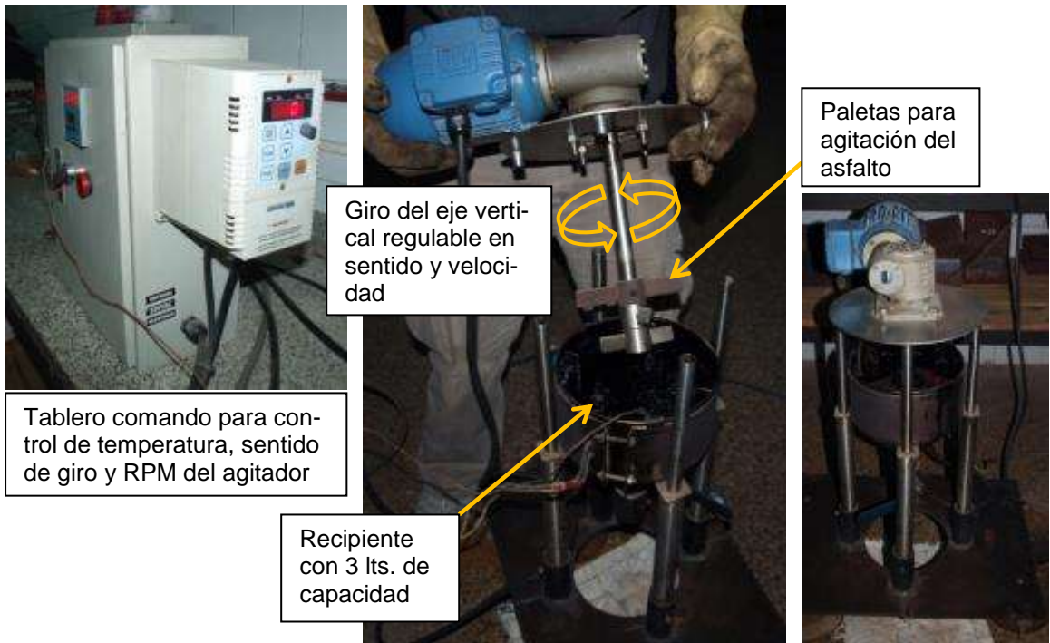
FOTO 7. DETALLE DEL DIGESTOR DE ASFALTO MODIFICADO
