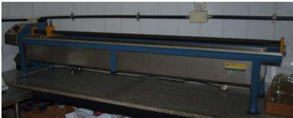
FOTO 14. PILETA PARA ENSAYO DE DUCTILIDAD
