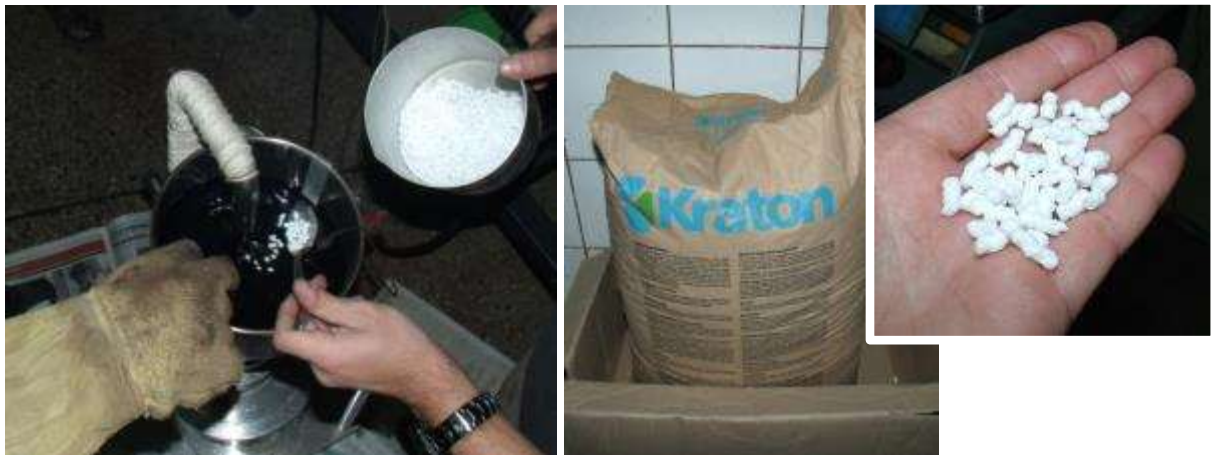
FOTO 3. INCORPORACIÓN DEL POLÍMERO KRATON A 180°C CON AGITACIÓN MANUAL
