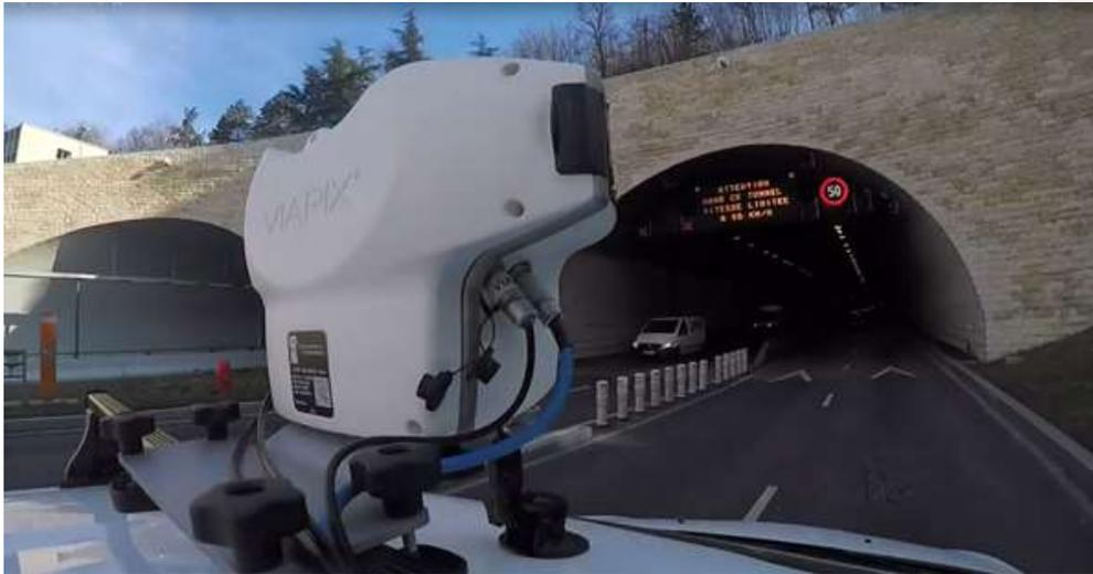
Figura 23: Sistema de Video y Mapeo Móvil próximo al ingreso a un túnel
