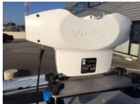
Figura 4: Sistema de Video y Mapeo Móvil instalado en un vehículo
