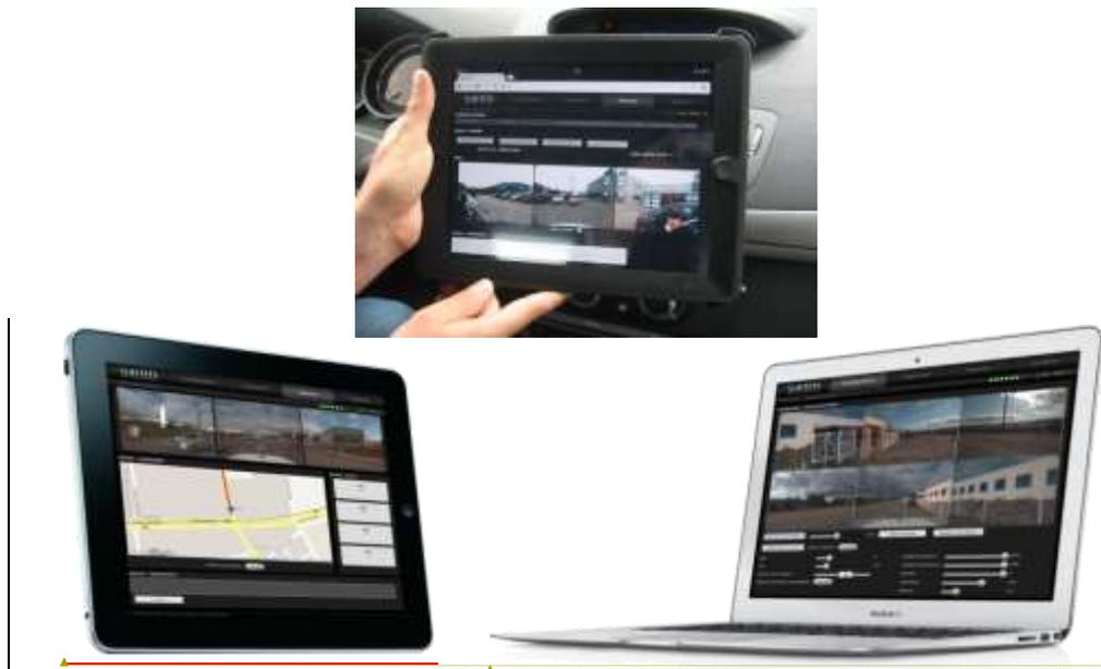
Figura 6: Tableta táctil WiFi–Notebook conectada a la interfase Web del sistema de adquisición
