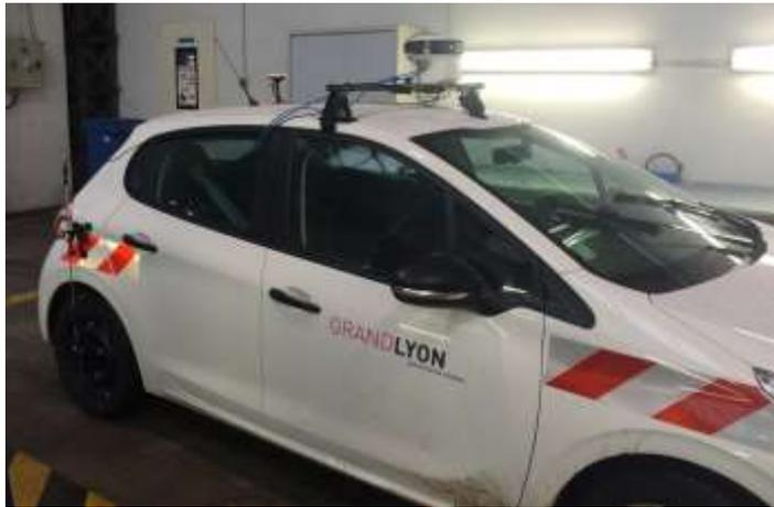
Figura 2: Sistema de Video y Mapeo Móvil empleado para el Grand Lyon
