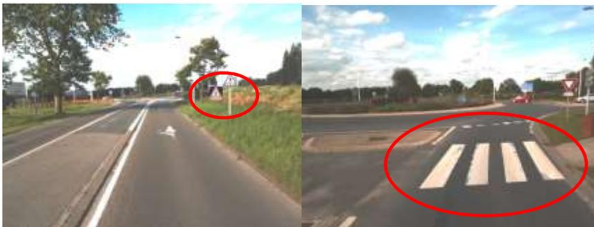
Figura 9: Señalización vertical y horizontal
