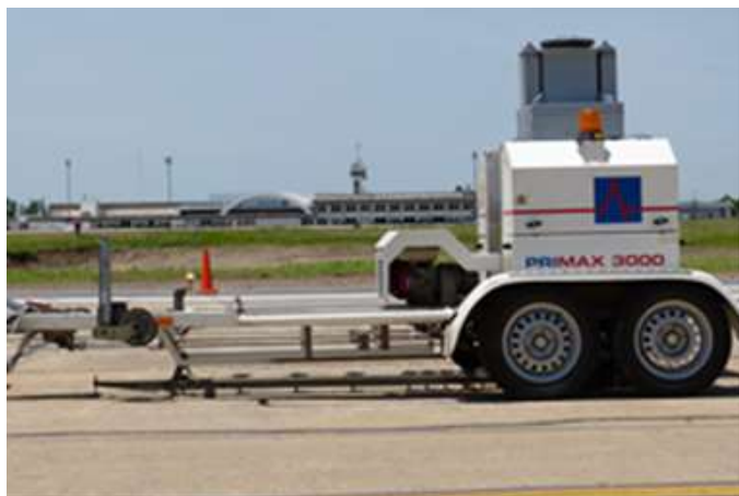
Figura 15: Equipo SHWD (Super Heavy Weight Deflectometer)
