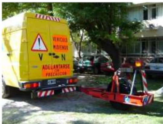
Figura 1: Rugosímetro BPR de la DNV
