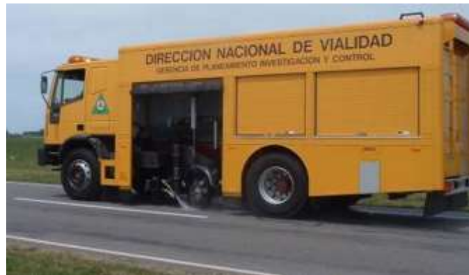
Figura 6: Equipo SCRIM para medición del coeficiente de fricción transversal y macrotextura mediante láser
