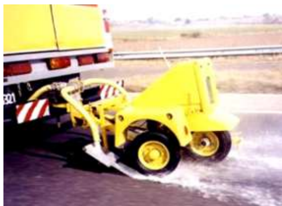
Figura 2: Mu Meter de la DNV. Coeficiente de fricción transversal
