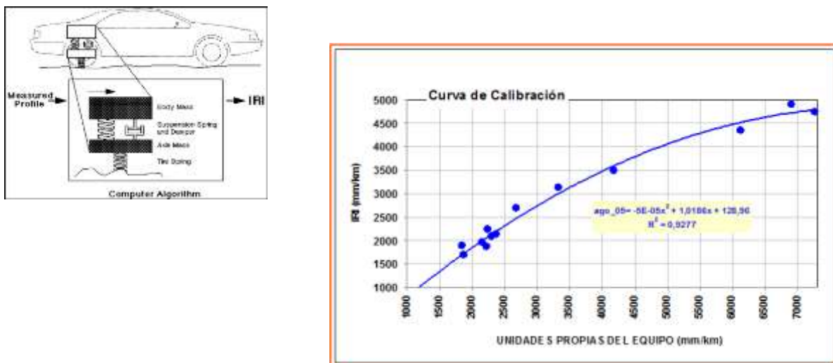
Figura 4: Rugosímetros tipo-respuesta. IRI estimado por correlación (Clase III s/[4])
