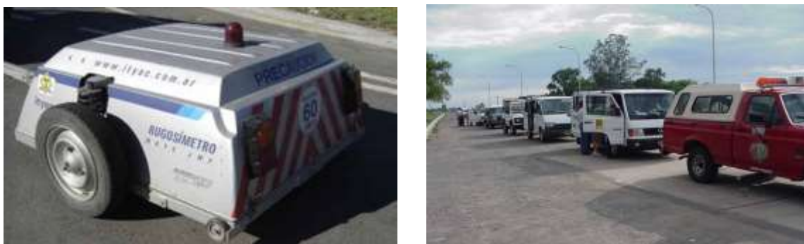
Figura 5: Rugosímetros tipo-respuesta. IRI estimado por correlación (Clase III s/[4])
