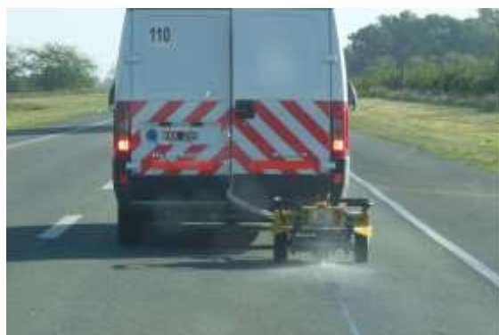
Figura 16: Equipo Grip Tester. Coeficiente de Fricción Longitudinal
