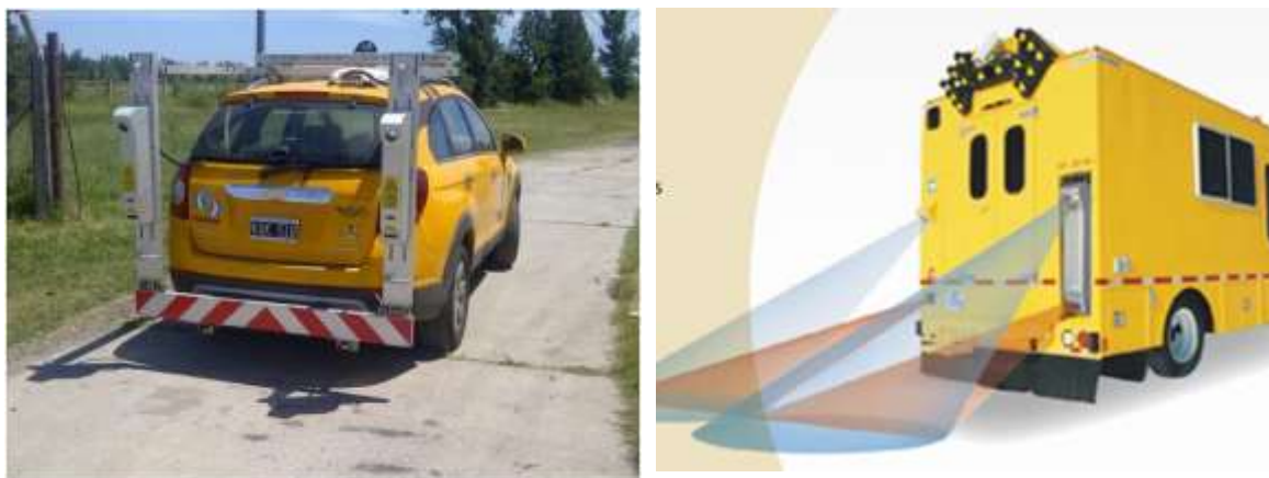
Figura 11: Perfilómetro Transversal Láser 3D de la DNV
