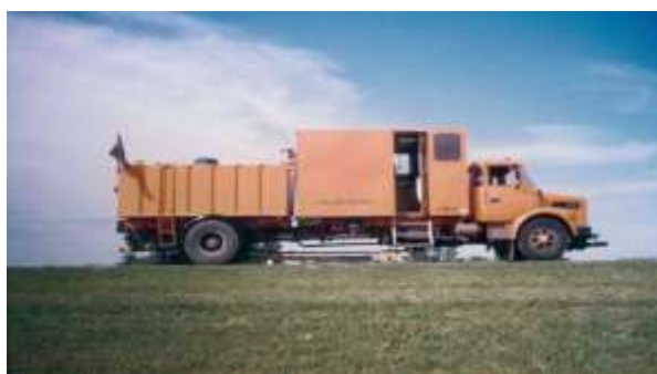
Figura 3: Primeras experiencias en el uso del deflectógrafo Lacroix en Argentina
