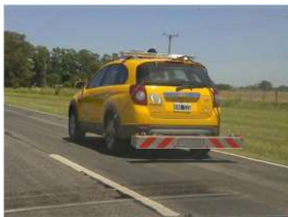
Figura 10: Perfilómetro MLPL en medición en ruta
