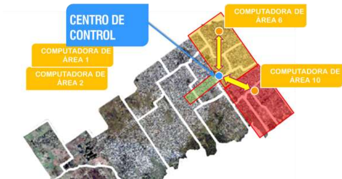
FIGURA N° 9. Plano de sector Este del Partido de La Matanza – Ubicación de Computadores de Área.
