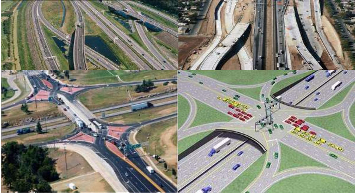
**Entrecruzamiento de ramas con cambio de sentido, a nivel o diferente nivel en tronco (Arriba) o distribuidores Abajo: (I) Distribuidor Diamante Cruce Doble, controlado por semáforos; (D) Distribuidor Diamante de Punto Único, controlado por semáforos**
