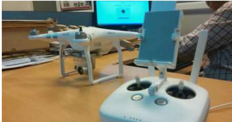
Figura 15. Equipo utilizado (Dron DJI Phantom III Advanced)
