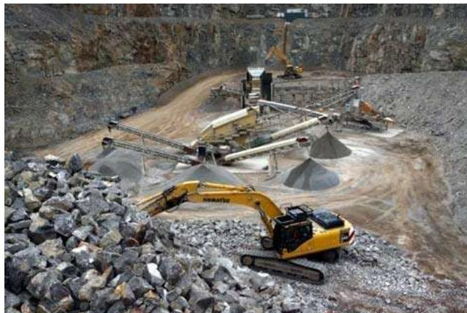
Foto 3 - Sistema primario y secundario de trituración
