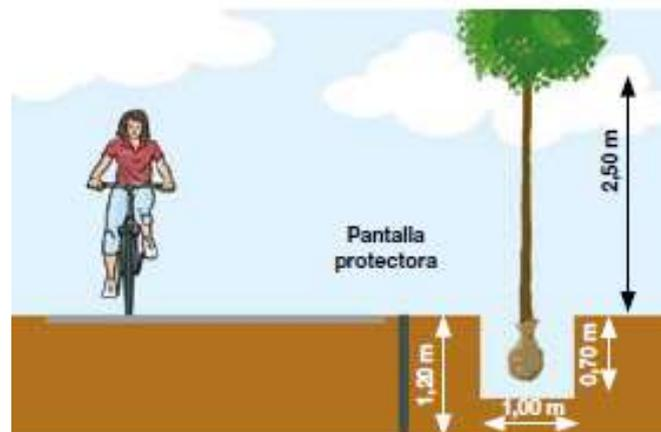
**Figura Nº 4: Esquemática de las barreras protectoras a implementar.**
