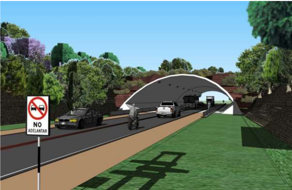
Figura N° 6: Representación esquemática de la estructura tipo arco propuesta.
