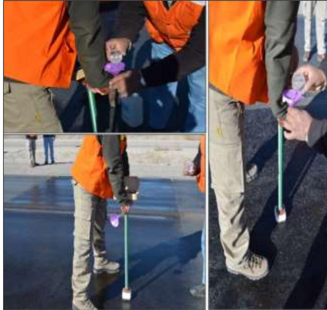
Figura 10. Procedimiento de medición de conductividad sobre pavimento
