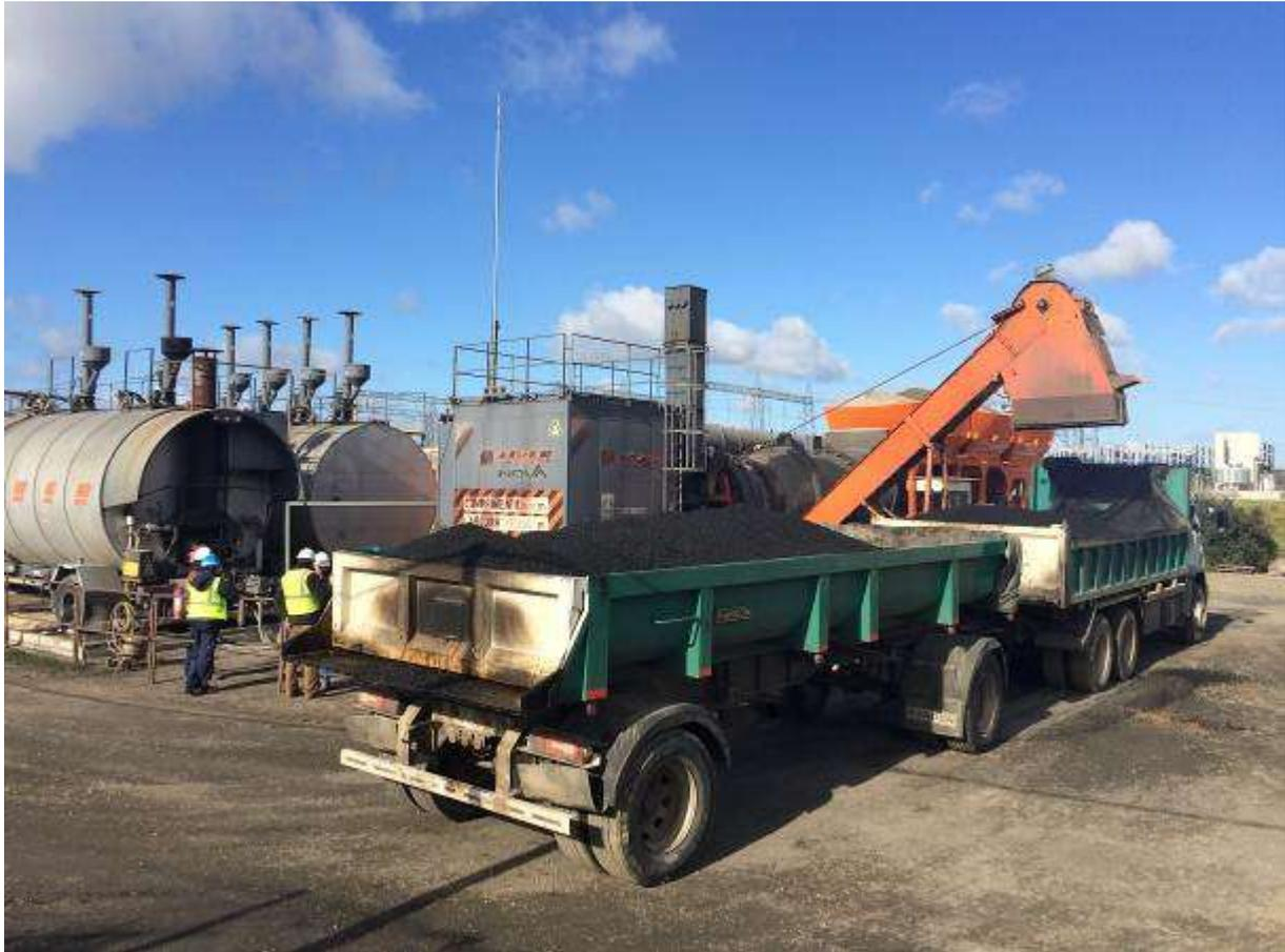
FIGURA 1: PLANTA DE ELABORACION DE MEZCLA
