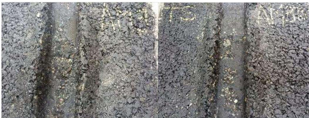
Hamburgo test para SMA 6 (6.3) con AM3 + fibras (izq) y AM3 TS (der) luego de 20000 pasadas
