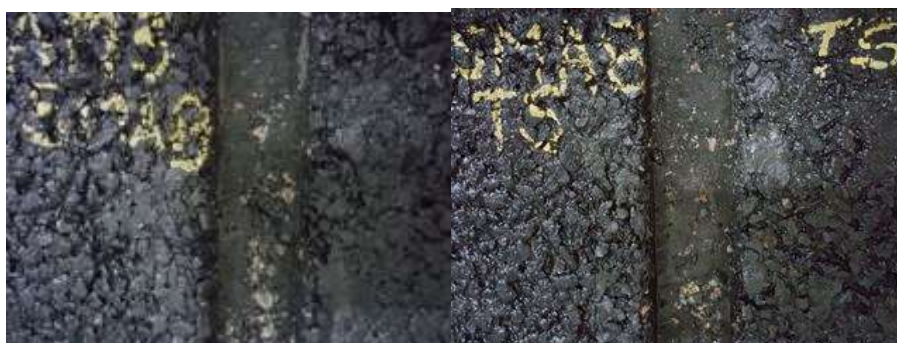
Figura 9: Hamburgo test para SMA 8 con AM3 + fibras (izq) y AM3 TS (der) luego de 20000 pasadas
