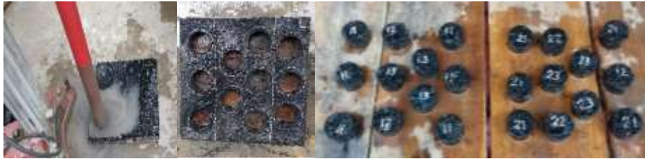
Foto 2 – Extracción de testigos. Probeta luego de la extracción. Testigos extraídos de las probetas 1 y 2 de microaglomerado discontinuo
