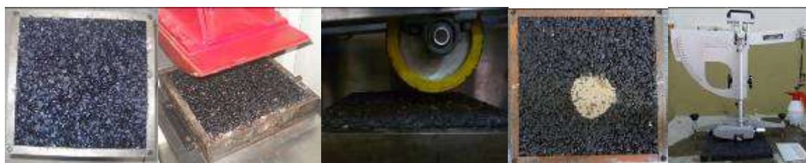
Foto 1 - Confección y compactación de las probetas. Simulación de tránsito. Ensayo de Parche de Arena y Péndulo TRRL
