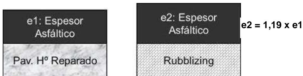
FIGURA 3. RELACIÓN ESPESORES DE REFUERZO
