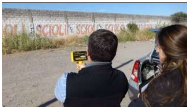
Figura 6. Medición con el aparato "DustMate" del polvo ambiental
