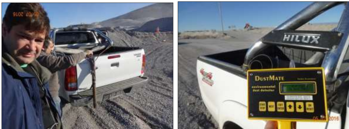
Figura 21. Disposición del sensor del aparato DustMate para las mediciones
