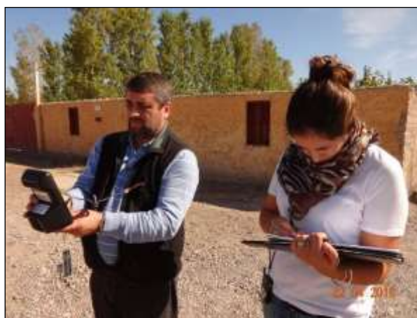
Figura 8. Medición de polvo con aparato "Dylos" en borde de camino
