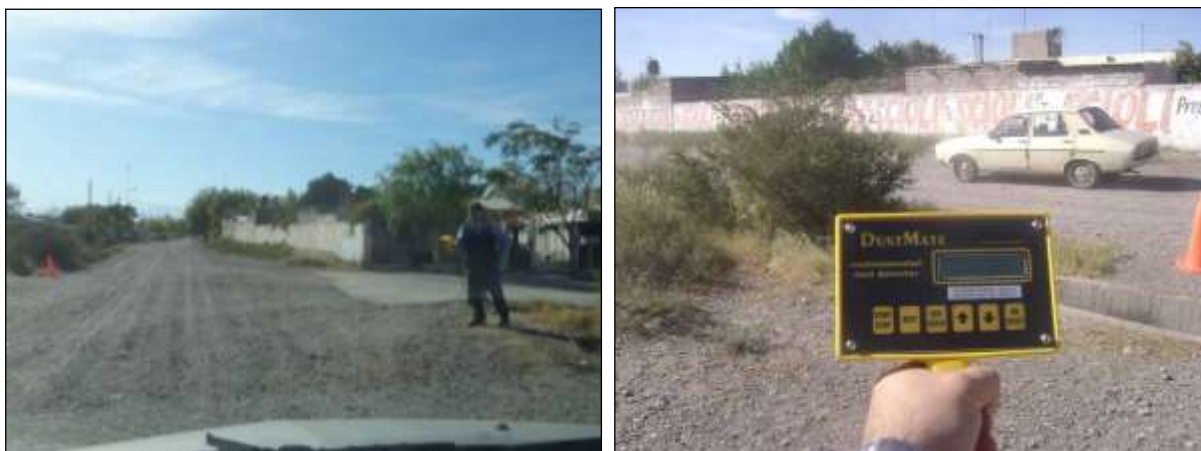
Figura 8. Mediciones de polvo con aparato DustMate a distintas distancias del camino
