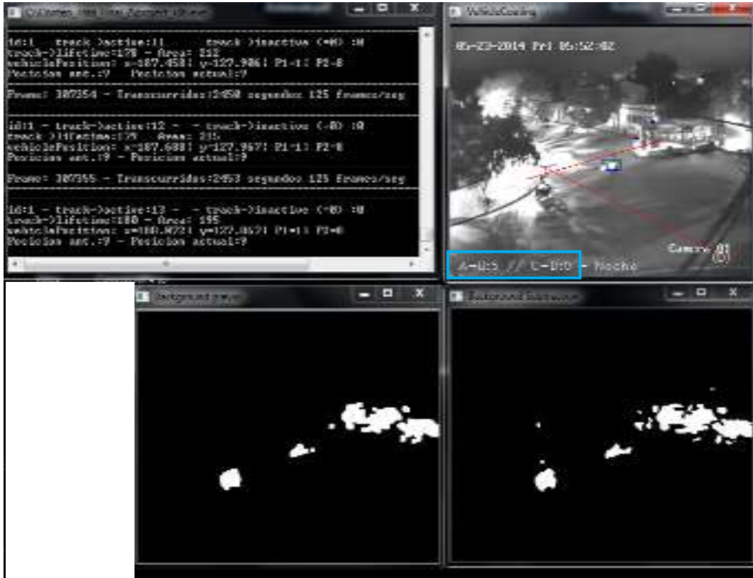
Imagen 6.2-11. Error debido a la falta de identificación de las motos. Fuente: Autor.
