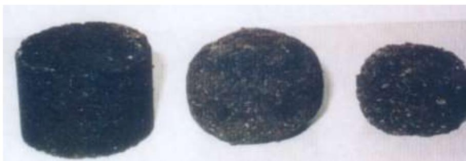
**Figura 1. Probetas UCL, efecto del ensayo Cántabro en seco y tras inmersión**
