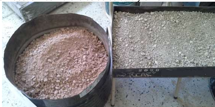
Figura 4. Suelos canteras Zona Concepción (izq) y Zona Paraná (der) Tabla 1 se indican las clasificaciones de los suelos calcáreos en su estado natural (acopio cantera) junto con la densidad seca máxima y humedad óptima del ensayo Próctor de referencia y los valores soporte e hinchamiento de ambas muestras.
