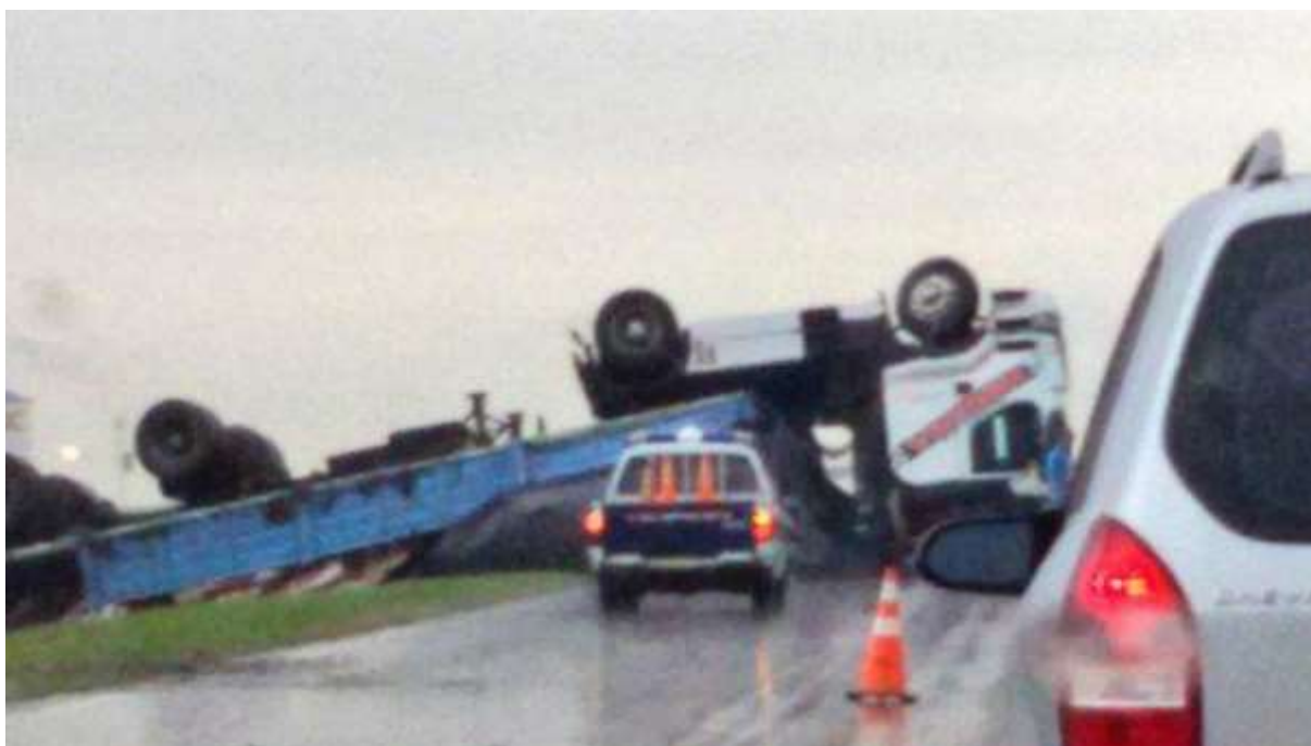
RN9 km 233 San Nicolás – Hidroplaneo – Banquina tierra – Taludes > 1:4
