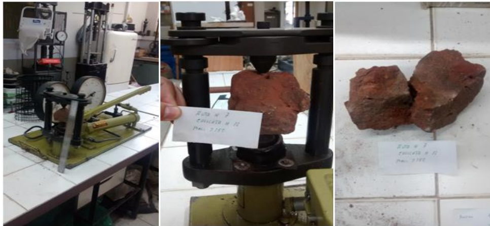
Fig. 8. Ensayo de carga puntual sobre un fragmento de roca representativo, zona de contratalud de la Ruta Provincial N° 7
