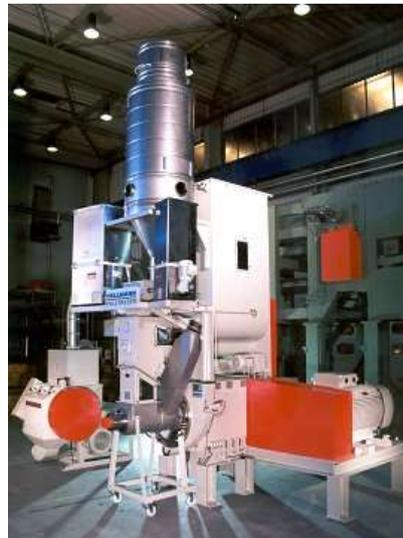
Figura 12: Molino para micronizado
