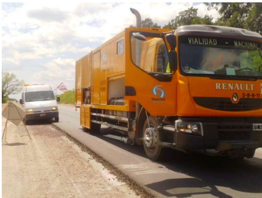
Imagen 35: Camión operando, midiendo deflexiones
