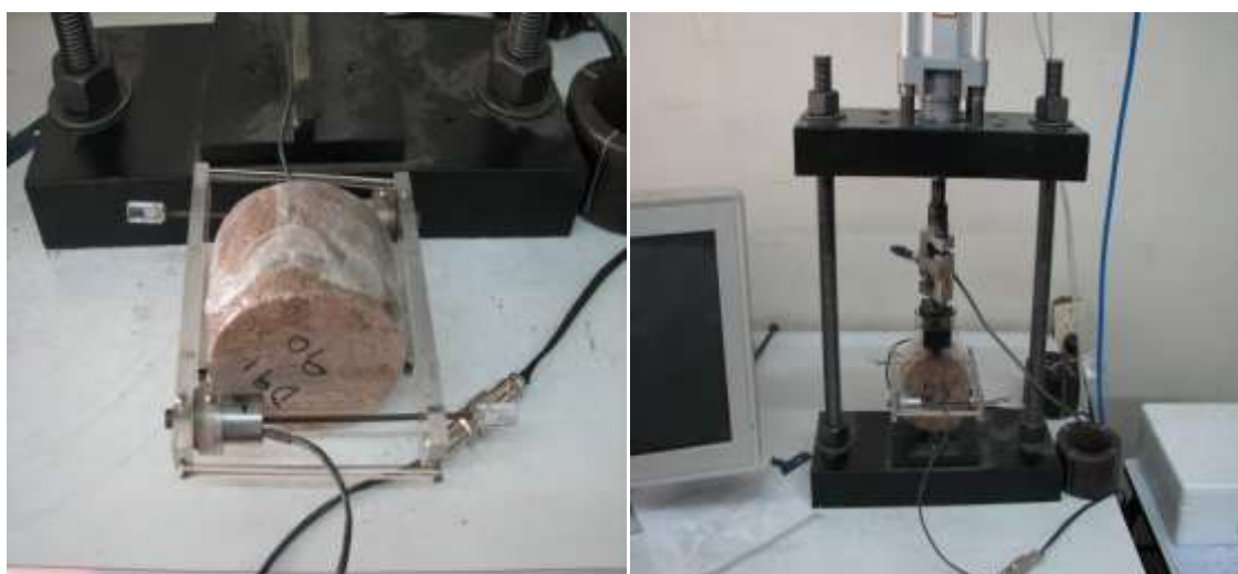
Fig. 14: Colocación de sensores en la probeta y montaje en el equipo de ensayo
