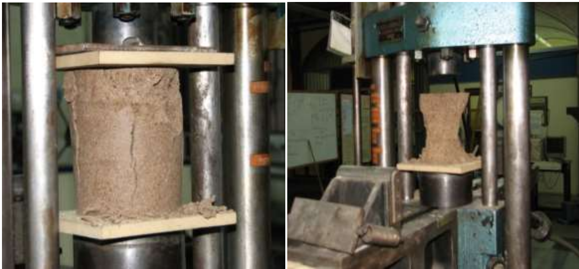
Fig. 12: Forma de rotura de las probetas ensayadas a compresión simple Tabla 6: Resultados del Ensayo de Resistencia a la Compresión Simple
