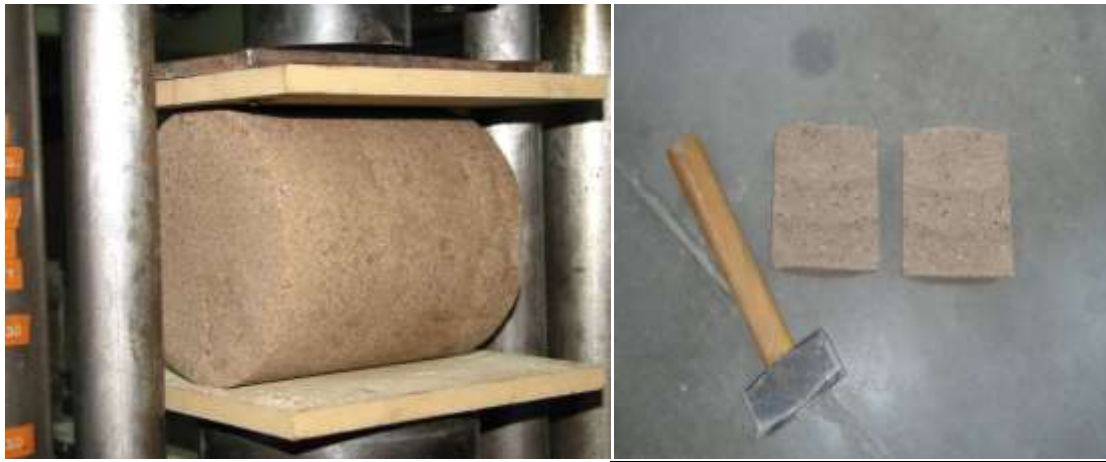
Fig. 13: Rotura de una probeta a compresión diametral
