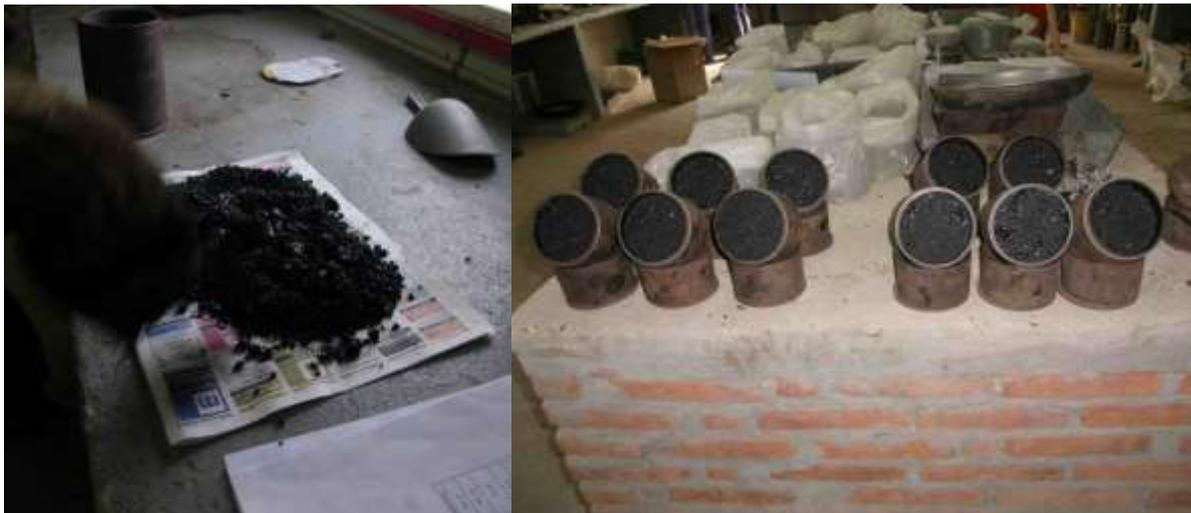
FOTO 3. Moldeos de probetas.
