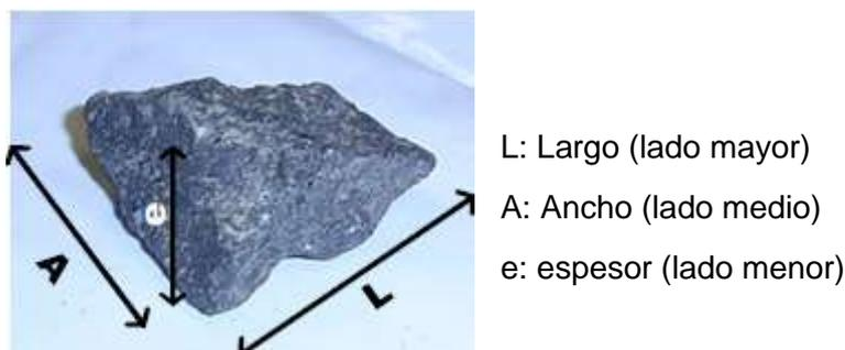
FIGURA 1. Dimensiones del agregado.
