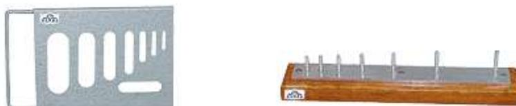
FIGURA 5. Calibres para determinación de índices de lajas y agujas.
