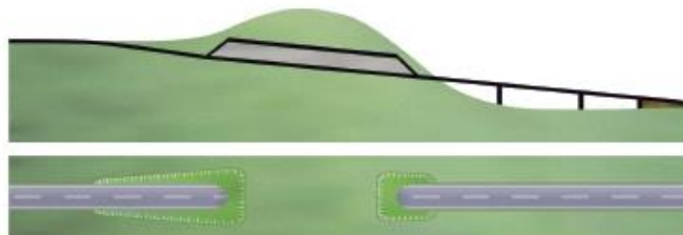
Figura 3.26. Representación esquemática de tres alzados de carretera en los que se muestran las posibilidades existentes de acoplar el trazado a la topografía local (A), desacoplarlo ligeramente para sobredimensionar estructuras (B), o desacoplarlo fuertemente para favorecer un trazado muy permeable (C).
