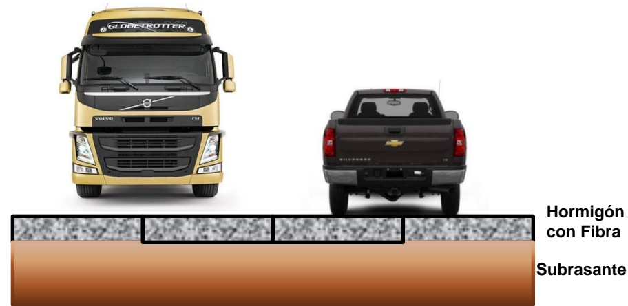
Pavimento Ultradelgado de Ho con fibra
