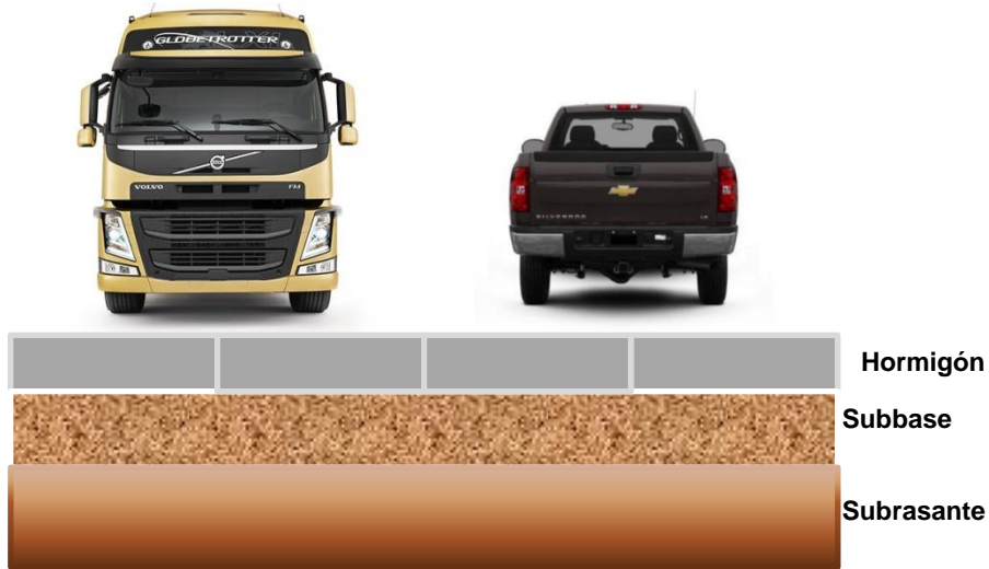
Pavimento Losa Corta
