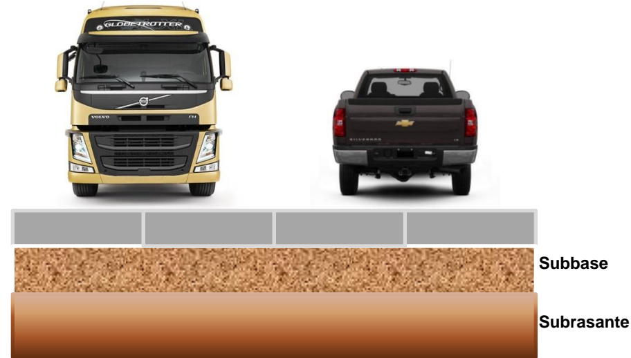
Pavimento Losa Corta
