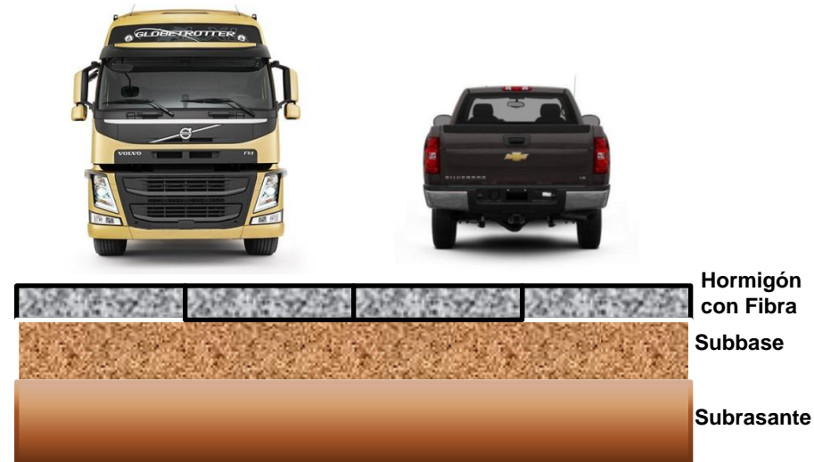
Pavimento Losa Corta
