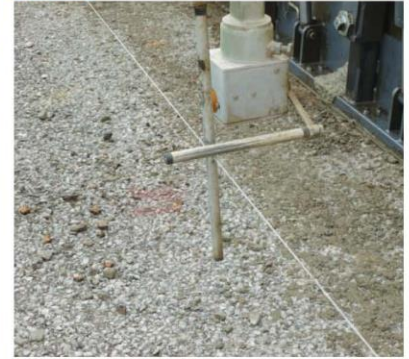
Figura 5-25: Sensores de alineación horizontal y vertical.
