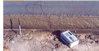
Figura 6-12: Ensayo para la determinación de la madurez.
