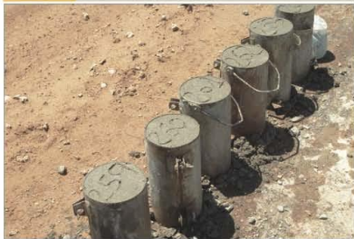
Figura 6-10: Probetas moldeadas en obra.
