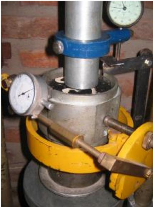
*“...La resistencia al corte en un concreto asfáltico es fundamental para oponerse a la deformación irrecuperable y ello se refleja en el mayor peso que la concede el SHRP a la estructura granular del mismo por su aporte friccional sin desconocer la incidencia del stiffness del ligante asfáltico.
