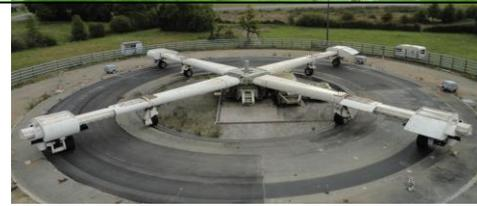
Comparación del ahuellamiento con diferentes ligantes con el sector testigo 50/70
