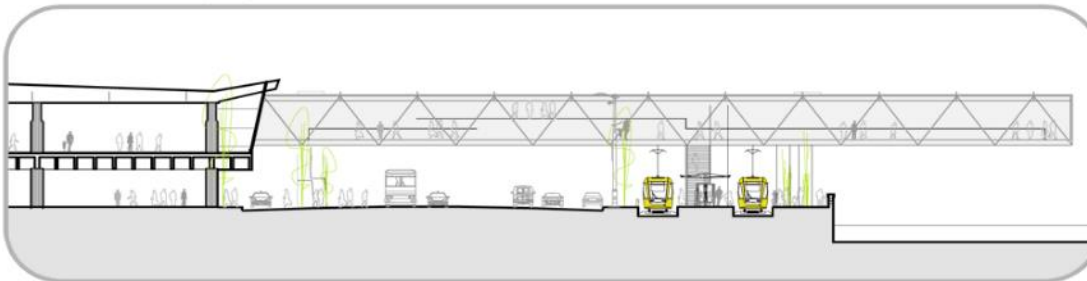
Seccion Transversal - Aeroparque - Terminal A - esc: 1:400
